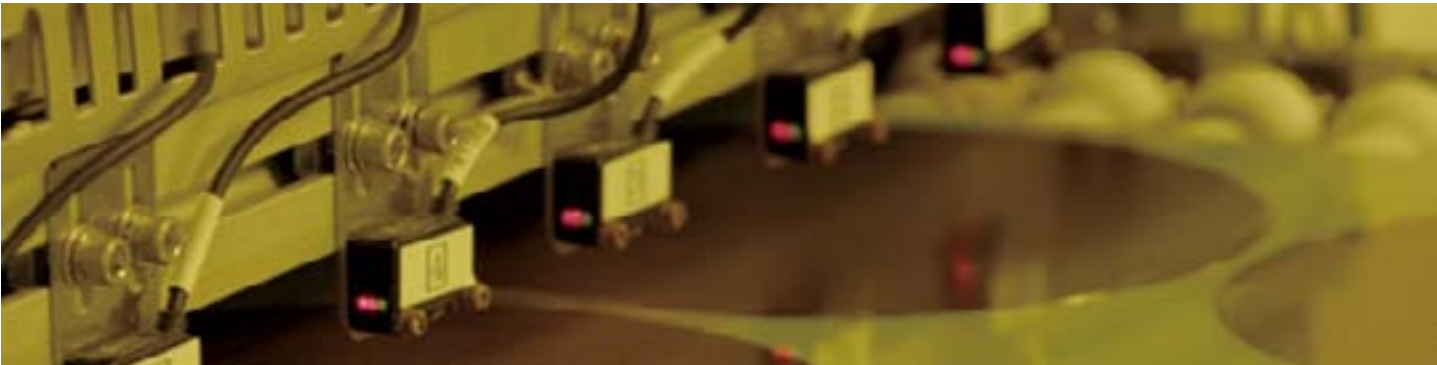
PLP는 LCD와 WLP 기술의 장점을 적용한 하이브리드 제조 패키지 기술이다. 기존에는 원형 기판에서 네모난 칩을 잘라내 테두리 부분은 쓸 수 없었지만, PLP는 사각형 기판 위에서 작업한다. 이에 따라 테두리 부분을 활용할 수 있어 사용 면적이 넓어지고 가격·생산성을 높일 수 있다.
